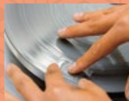
研磨作業：回転する鋳板上で感覚を頼りに薄くしていく
