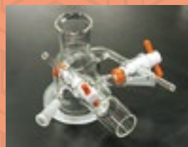
化学実験に用いる特注光学セル
