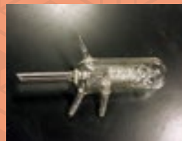
複雑な構造を組み込んだ化学実験に用いる冷却器
