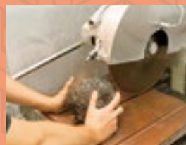
岩石の切断作業: 大型試料から微細試料の切断が可能
