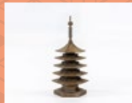
ワイヤー放電加工機によって精密に再現された五重塔
