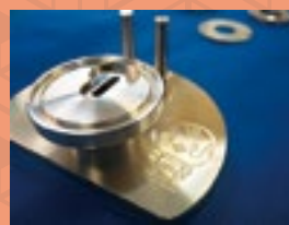
微小試料観察の事前準備としてAu薄片への圧着を行うための特注器具
