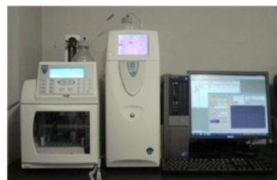
図2 イオンクロマトグラフ装置 ICS1600
