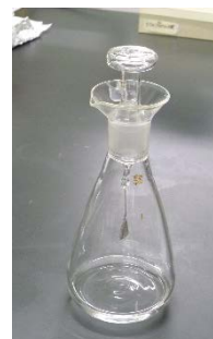
図1 酸素燃焼フラスコと白金網付き栓
