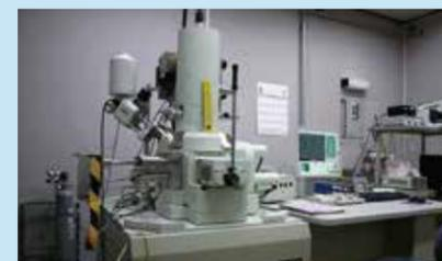
電界放射型走査型電子顕微鏡
