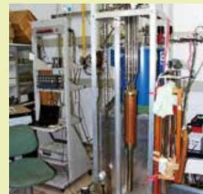
極低温微小試料比熱測定システム
