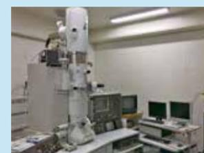
電界放射型透過型電子顕微鏡
