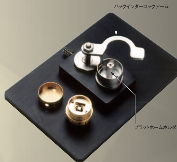
比熱測定用試料取り付けステーション
